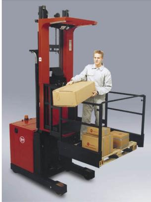
Das OPW Kommissioniergerät wurde speziell für den Transport von langen Lasten auf Standardpaletten und Speziallastenträgern entwickelt. Große, sperrige Lasten werden am besten mit dem OPW SPACE transportiert.
