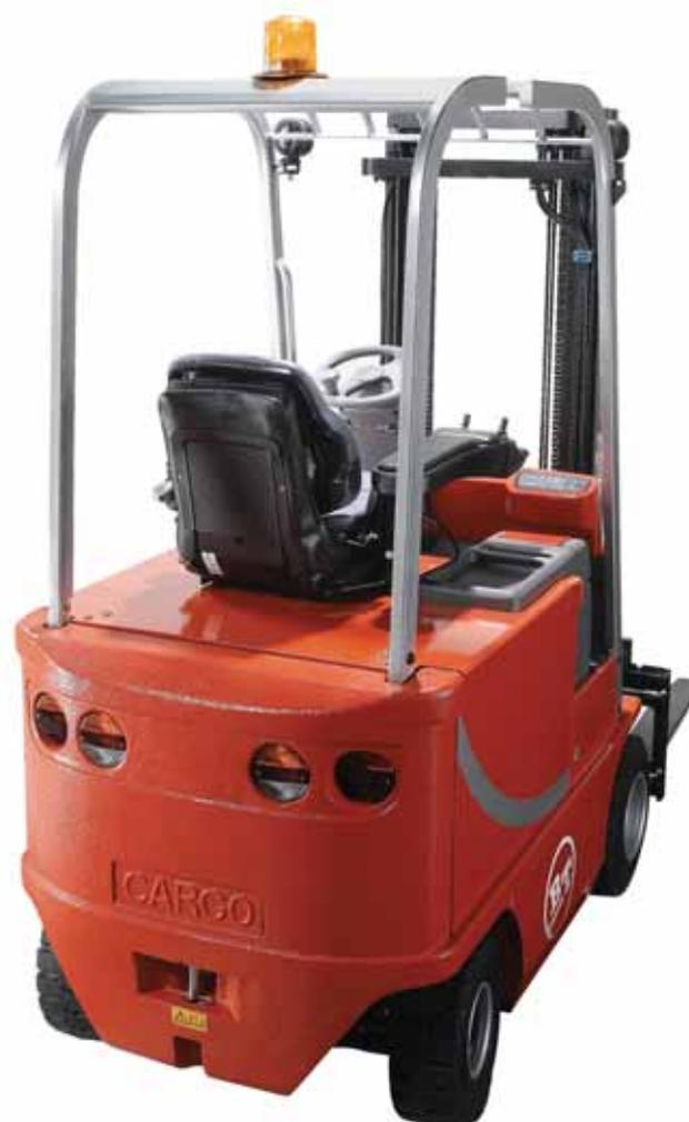
Die neue Baureihe C4E160NL-200NL vereint die Vorteile der AC Technologie mit einem hohen Maß an Manövrierfähigkeit, die durch die Positionierung der Batterie über der Hinterachse ermöglicht wird (kürzere Gesamtlänge). Zwei unabhängig angetriebene AC Antriebsmotoren an den Vorderrädern dienen als elektronisches Differential und ermöglichen den Einsatz auch auf engstem Raum.
