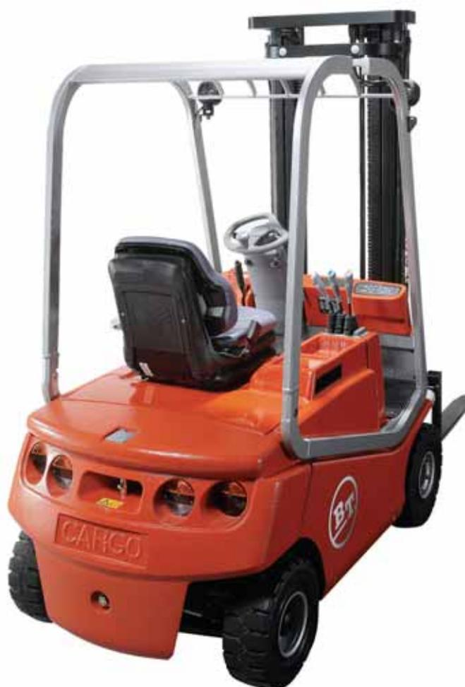
Dieser Elektro-Frontstapler mit AC-Technologie mit 4-Rad-Chassis wurde für vielfältige Einsätze entwickelt. Das äußerst fahrstabile und wendige 4-Rad-Chassis mit dem weit nach unten verlagerten Schwerpunkt verfügt über zwei unabhängig angetriebene Vorderräder. Die leistungsstarken 48 V AC Antriebsmotoren verleihen dem Stapler zusammen mit dem elektronischen Differential sehr gute Manöviereigenschaften.
