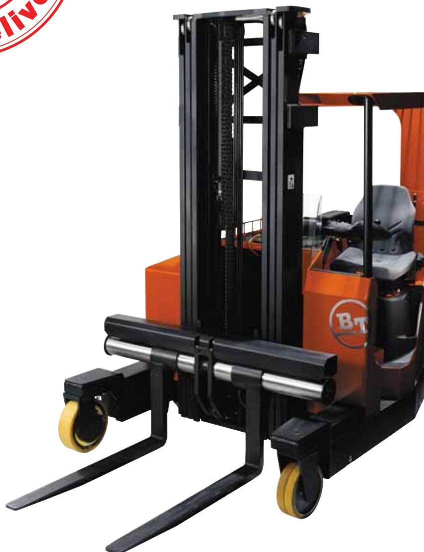
Der Freflex FRE270 ist ein Vierwege-Schubmaststapler von BT, der die Vorteile modernen Designs und der Drehstromtechnik miteinander verbindet. Ein Garant für hohe Produktivität bei der Handhabung langer und sperriger Lasten sowie konventioneller Paletten auf engem Raum.
