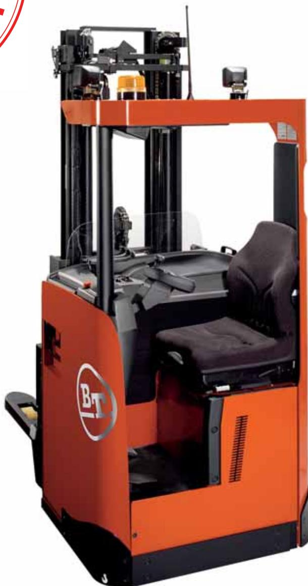
Die Stratos SRE Elektro-Sitzstapler sind verfügbar in den Tragfähigkeiten 1.350 kg und 1.600 kg. Die vier Modelle mit festen oder hebbaren Stützarmen sind verfügbar mit Hubhöhen von bis zu 6.300 mm.
