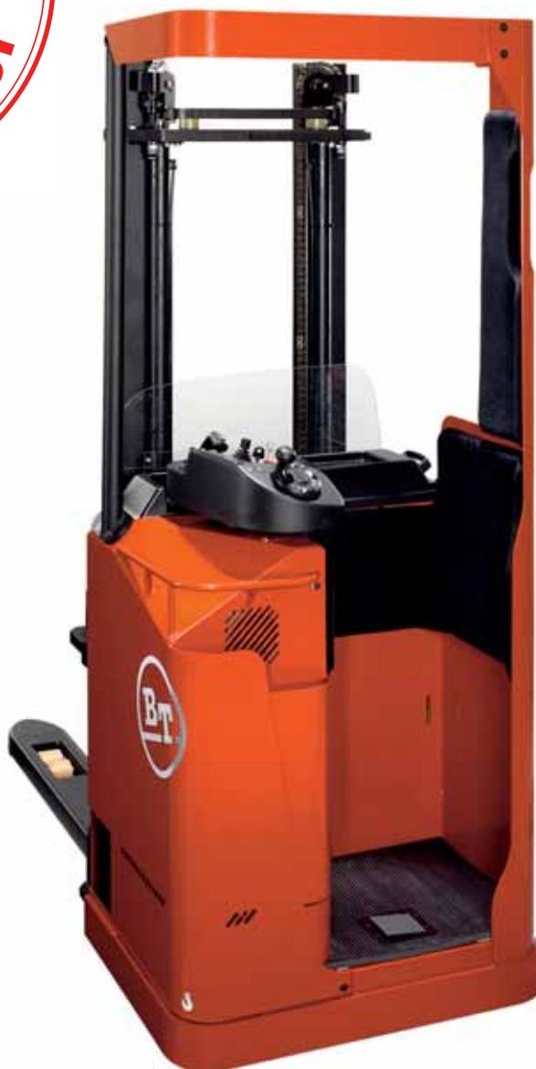
Die Geräte Stratos SSE bieten dem Fahrer eine geschlossene Fahrerkabine mit Stehhilfe und garantieren dadurch ein Maximum an Geschwindigkeit und Flexibilität. Die Stapler verfügen über 1350 bzw. 1600 kg Tragfähigkeit und eine maximale Hubhöhe von 6,3 m.
