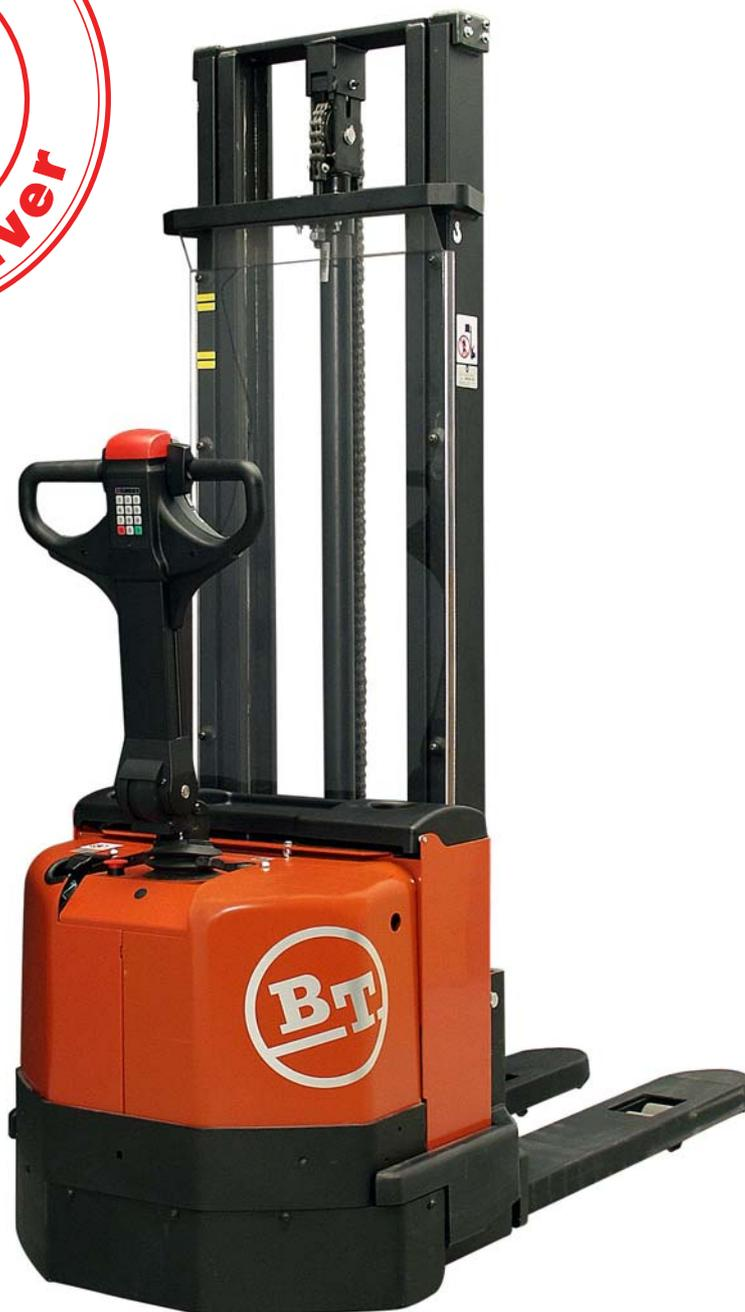
Der SWE100/120 wurde speziell für Anwendungen in Ladenlokalen, Produktionsbetrieben oder kleineren Lägern entwickelt. Diese Elektro-Deichselstapler haben trotz ihrer geringen Größe ein hohes Leistungsvermögen. Die Chassisbreite von nur 800 mm und die 208° Lenkung sorgen für eine ausgezeichnete Manövrierfähigkeit.
