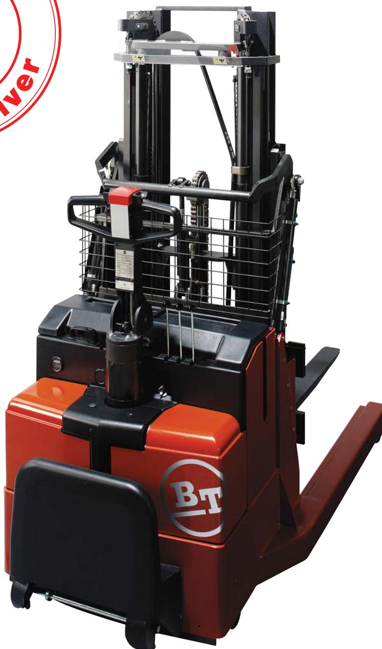
Der RWE120 kombiniert das kompakte Chassis eines Elektro-Deichselstaplers mit der Flexibilität eines Schubmaststaplers. Dies ermöglicht den Transport von unterschiedlichen Palettentypen und benötigt dabei ein Minimum an Arbeitsfläche.
