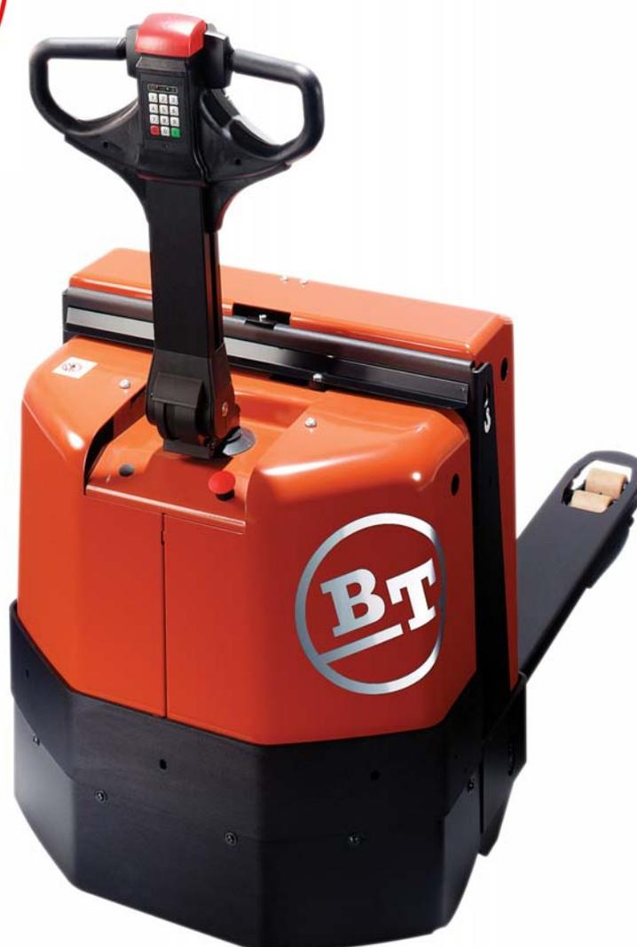
Die LWE Elektro-Deichsel-Niederhubwagen der Orion Baureihe eignen sich besonders für das Be- und Entladen im Mitgängerbetrieb sowie für den horizontalen Transport.
