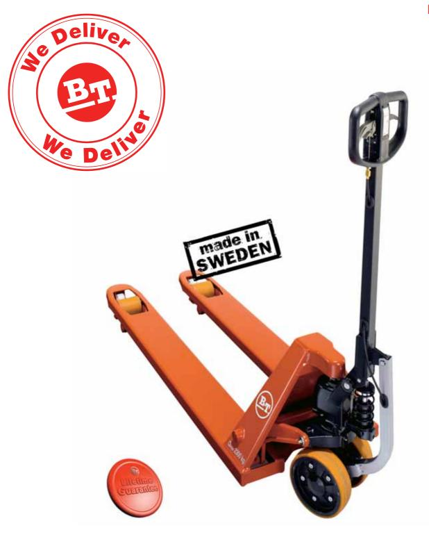
Der erste Schritt ist immer der schwerste. Der BT Pro Lifter macht ihn von selbst. Man benötigt eine Kraft von 45 kg, um einen mit 2.300 kg beladenen Handhubwagen in Bewegung zu setzen. Mit BT Pro Lifter wird dieser Kraftaufwand auf 15 kg reduziert.
